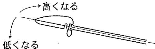
●スピーダの調整…スピード調整ハンドルのロックナットをゆるめてハンドルを右へ廻すとスプリングが強くなってスピードが増し、左へ廻すとスローになります。
