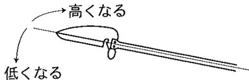
●スピードの調整…スピード調整ハンドルのロックナットをゆるめてハンドルを右へ廻すとスプリングが強くなってスピードが増し、左へ廻すとスローになります。
