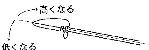
●スピードの調整… スピード調整ハンドルのロックナットをゆるめてハンドルを右へ廻すとスプリングが強くなってスピードが増し、左へ廻すとスピードになります。
