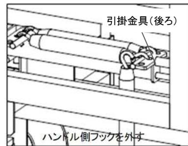
※速度調整ハンドルは、ネジ部先端を超えて緩めすぎると脱落しますので、注意してください。
