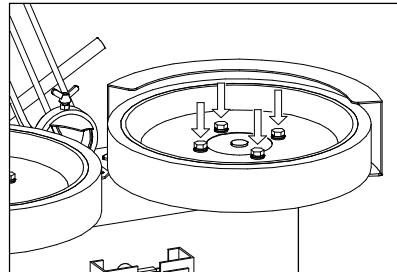
**i** ローターとローター軸との“はめ合い寸法”は、ローターの回転精度を確保するため厳しくできています。ローター軸についた鋸びや付着物などにより、うまくはめ合わない場合があります。無理にはめ込まず鋸びや付着物を取り除いてから取り付けてください。
