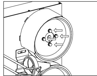
**i** ローターとローター軸との“はめ合い寸法”は、ローターの回転精度を確保するため厳しくできています。ローター軸についた鋲びや付着物などにより、うまくはめ合わない場合があります。無理にはめ込まず鋲びや付着物を取り除いてから取り付けてください。
