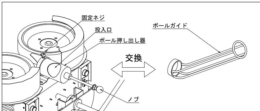
※ノック用ボール押出器は、本体上部の角度を大きく上向きにとるフライ系ノックを射出する場合のみ使用してください。
