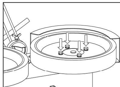
⑤ローターカバーなどに接触する箇所がないか、左右のローターの平行がとれているか確認してください。
