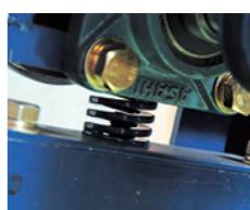
球する瞬間にローターが下方向へ下がるため、ボールやローターの消耗を抑えることができます。
