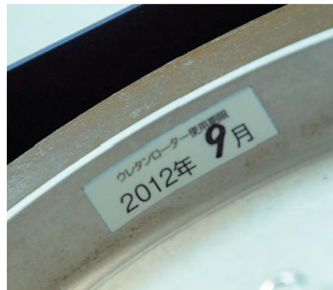
★ローターのゴム・ウレタンは日々劣化していきます。そのためアルミ部とゴム・ウレタンとの接着強度も落ちていきます。古くなり劣化したローター(ヒビ割れ、弾力性が劣るなどの症状が見うけられるローター)は高速回転させると遠心力によりゴム・ウレタンが欠けて飛び大変危険ですので絶対に使用しないでください。
