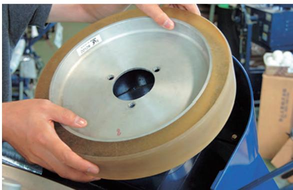
4.新しいローターをローター軸の上におき、ローターの穴とローター軸のネジ穴を合わせます。
