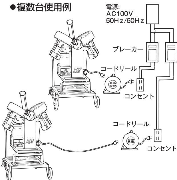
★マシン使用前には、必ず、電源コードに傷などがないことを確認してください。万一、被覆に傷があり、**銅線が見えている場合は、使用しないでください**。
