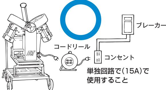
★マシンを同時に数台使用する場合は、必ず下図のような配線で、電源を引いてください。
