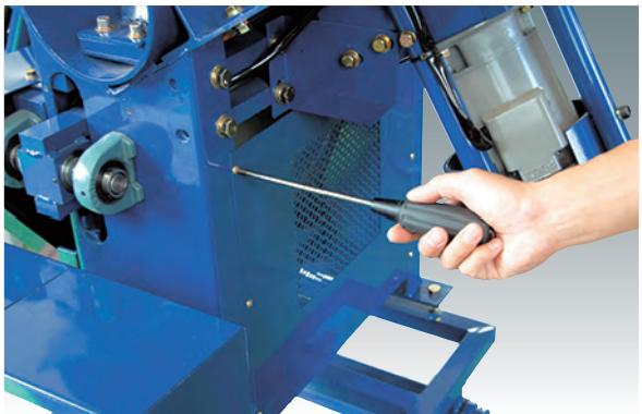
7.ローターを止めている3個所のボルトを付属の六角レンチを使用して緩め取り外します。
