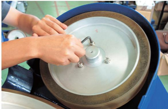
3.ローターを両手で持ち上げて、ローター軸より取り外します。
