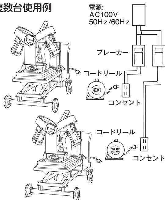
★マシン使用前には、必ず、電源コードに傷などがないことを確認してください。万一、被覆に傷があり、**銅線が見えている場合は、使用しないでください。**
