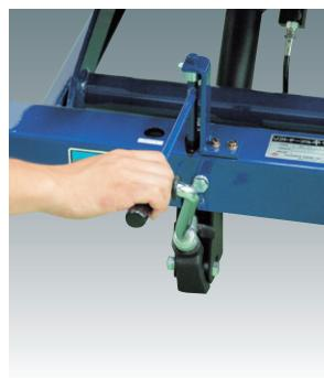
12.コントロールの確認をしていきます。ボールが上下にずれている場合は上下調整ハンドルで調整します。左に回せばボールは高めに投球され、右に回せばボールは低めに投球されます。
