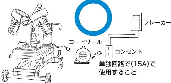
★マシンを同時に数台使用する場合は、必ず下図のような配線で、電源を引いてください。
