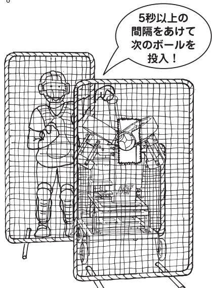
3. マシン本体や使用するネットに異常箇所がないか点検してください。特にローターは高速回転しますので、ハガレ、キズ・裂け目の有無やアルミ部にヒビ割れ・ブレがないか確認してください。
