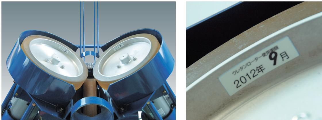
★ローターのゴム・ウレタンは日々劣化していきます。そのためアルミ部とゴム・ウレタンとの接着強度も落ちていきます。古くなり劣化したローター(ヒビ割れ、弾力性が劣るなどの症状が見うけられるローター)は高速回転させると遠心力によりゴム・ウレタンが欠けて飛び大変危険ですので絶対に使用しないでください。
