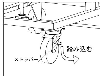
**!** 4つの車輪がすべて地面に接しマシンの荷重が平均的にかかる場所に置いてください。マシンが不安定な場合コントロールが定まらずにデッドボールのおそれがあります。
